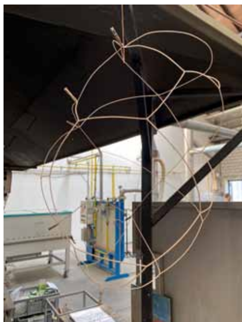
Das «Gstältli», in das hinein die glühende Glasmasse von Mund geblasen wird
