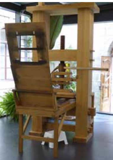
Auf dieser Gutenbergpresse wird im Genf eine Jubiläumsausgabe der Bibel gedruckt: Auf handgeschöpftem Papier der Basler Papiermühle und mit ihrem Textsatz und ihren Druckplatten. Foto rm.
